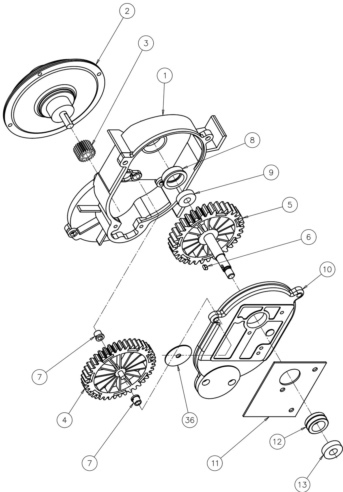
図2. ワイヤ送給減速機分解図
